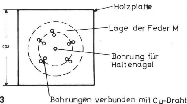
Man bohrt sich in das Brettchen kleine Löcher und befestigt die Feder mit dünnem Kupferdraht.
