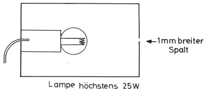
nur wenig verrückt werden. Da die Zylinderwand in dieser Höhe immer beschlagen ist, muß man die Einstrahlungsstelle vor jeder Beobachtung abwischen. Als Beleuchtungsquelle eignet sich **hervorragend** ein Diaprojektor mit einem Dia im Strahlengang, das bis auf einen winzigen lichtdurchlässigen Schlitz mit schwarzem Papier beklebt ist.
