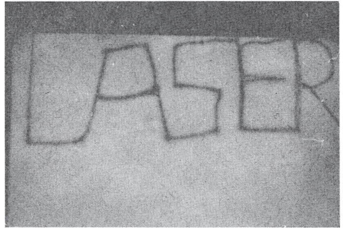
Abb. 3. ZnS-Schirm 30 sec nach laserinduziertem (632,8 nm) H \rightarrow L -Übergang
