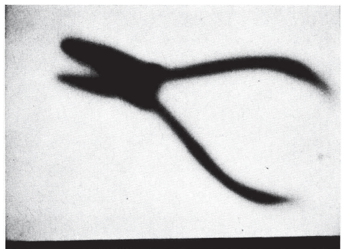
Abb. 2. ZnS-Schirm 30 sec nach thermisch (heiße Zange) induziertem H \rightarrow L -Übergang
