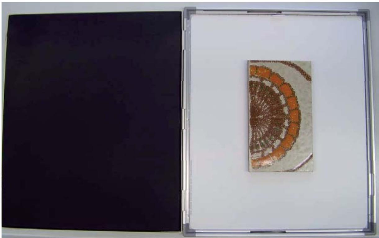
Geöffnete Expositionskassette mit Screen und Untersuchungsprobe ( $\text{UO}_x$  – glasierte Fliese)
