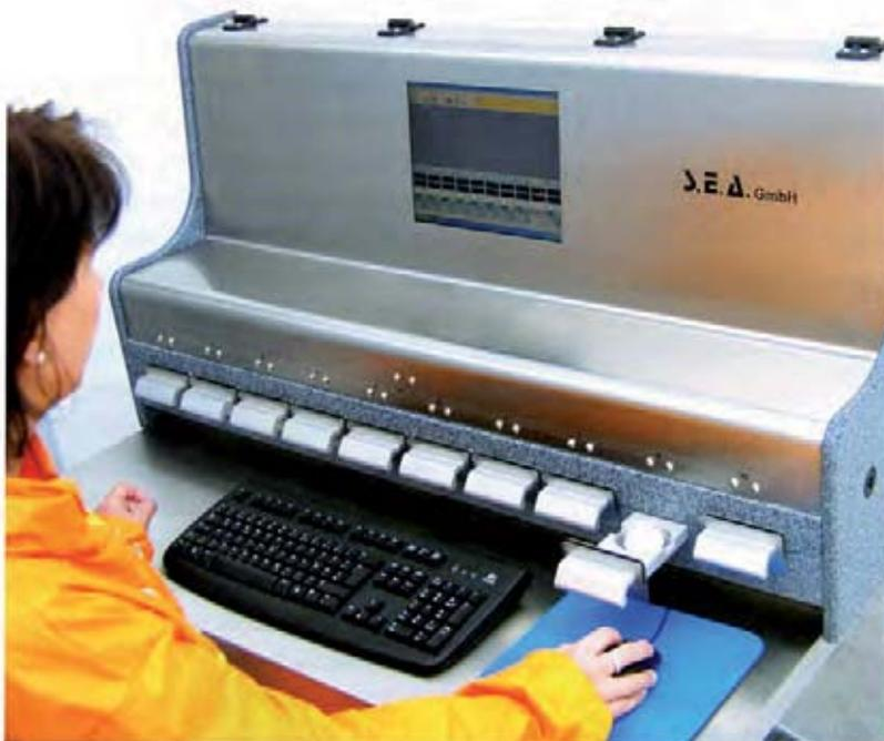
Abb. 2: PC-gestützter Zehnfach-Wischttest-Messplatz WIMP 60 x 10
