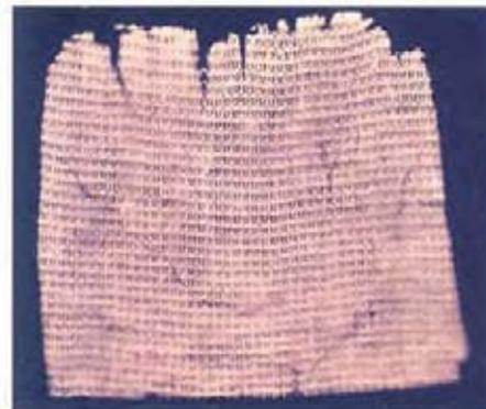
Abb. 3a. Autoradiographie eines Ausschnitts eines aufgespannten, nicht abgeflamten Glühstrumpfs (aufgepresst auf die Filmschicht)
