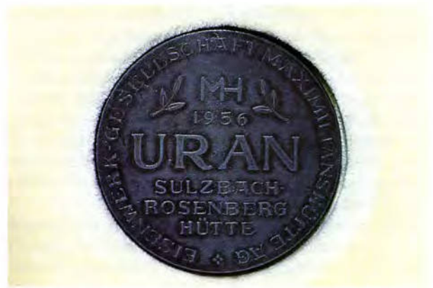
Abb. 4a. Bergbaumedaille aus Uranmetall, Gamma-Oberflächendosisleistung = 33 µSv/h, Uranversuchsbergbau Rudolfstein: Gewerkschaft Werra, Weißenstadt i. F., der Maximilianshütten AG., Sulzbach-Rosenberg (m = 117,3 g; Ø = 52,2 mm, d = 3,1 mm; Zusammensetzung s. Tab. 1). Prägung: Eisenwerk-Gesellschaft Maximilianshütte AG, MH 1956, URAN, Sulzbach-Rosenberg Hütte.
