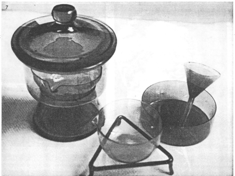
Abb. 7. Die Quarzgefäße wurden massiv durch die Strahlung der Radiumsalze angegriffen. Die Braun-Violett-Färbung weist auf die Erzeugung von sogenannten F-Zentren hin. In der Glasdosimetrie wird dieser Effekt zur meßtechnischen Erfassung kleiner Strahlungs Dosen angewendet. Die abgebildeten, nur geringfügig kontaminierten Laborgeräte von beträchtlichem wissenschaftsgeschichtlichen Wert fielen der „Strahlenschutzwut“ einer Verwaltungsangestellten eines großen Museums zum Opfer. [Photo: Deutsches Museum, München]
