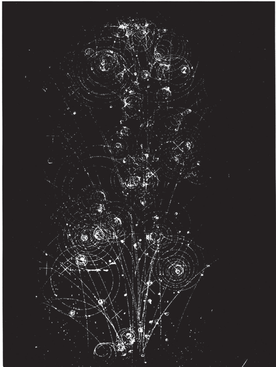
Abb. 3. Erzeugung von Elektron-Positron-Paaren aus hochenergetischen Photonen. Die beiden entgegengesetzt geladenen Teilchen bewegen sich unter dem Einfluß eines Magnetfeldes spiralförmig auseinander. (Photo DESY, Hamburg)
