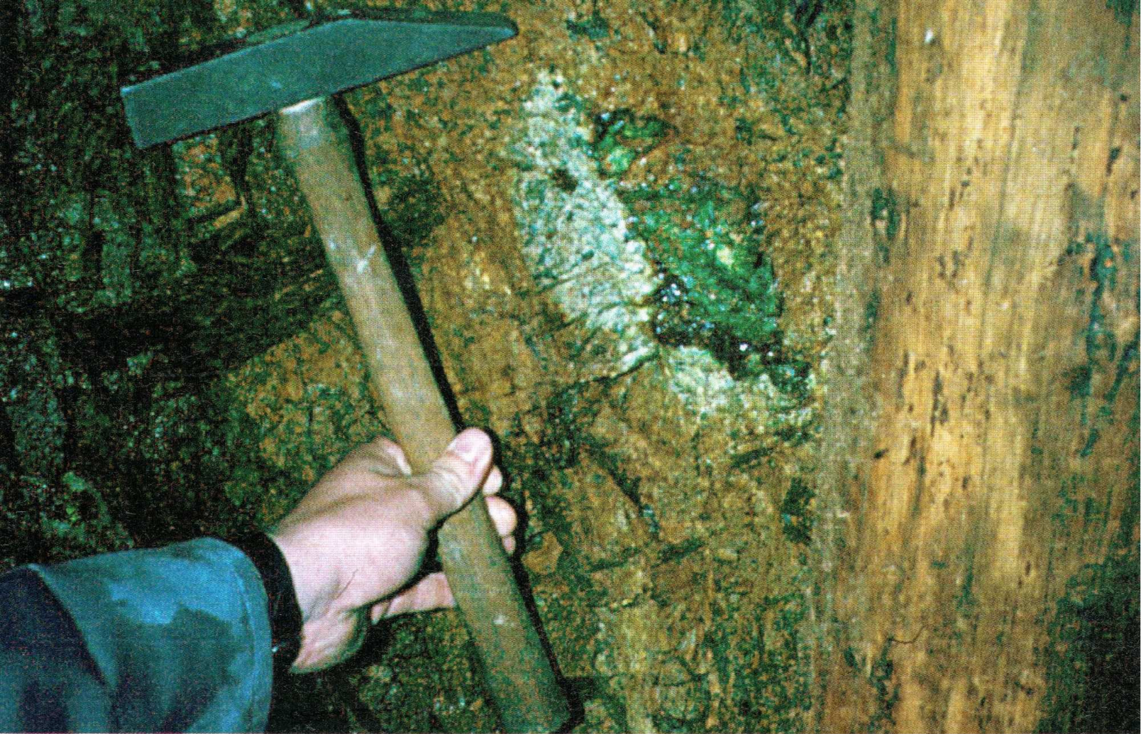
Uranpechblende (schwarz) umgeben von einer Corona mit Uransekundärmineralien, in diesem Falle vorwiegend Torbernit, der durch die grüne Farbe kenntlich wird. Uranuntersuchungsstollen Schirmberg der Saarberg-Interplan-Uran.
