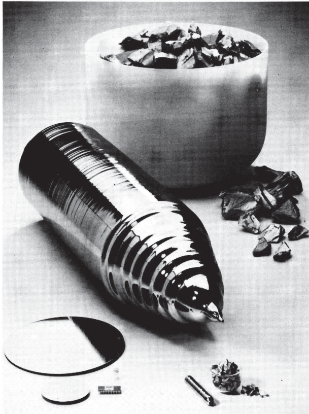
Abb. 5 Produktentwicklung in den letzten 25 Jahren: Rechts vorne: 1. Stab aus einkristallinem Reinstsilicium mit dazugehörigem Quarztiegelchen gefüllt mit polykristallinem Reinstsilicium (aus dem Jahre 1960). Bildmitte: Stab aus einkristallinem Reinstsilicium (1986) mit einem Durchmesser von 150 mm und dem entsprechenden polykristallinen Reinstsilicium. Links vorne: Scheiben aus einkristallinem Reinstsilicium und fertige IC's als Endprodukt (Photo: Wacker-Chemitronic GmbH, Burghausen)
