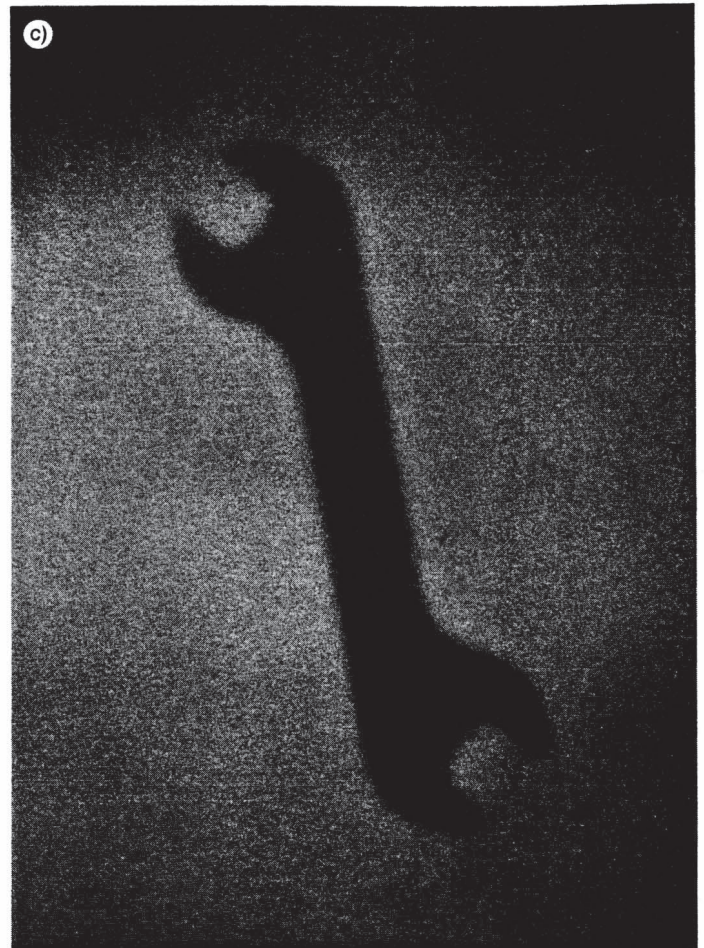
Abb. 7: Evolution der Thermolumineszenz einer erregten ZnS(Cu)-Kunststoffmatrix. a: Mit dem Beginn des Aufpressens (Kontaktzeit = 20 s) eines zuvor im Wasserbad erwärmten flachen Werkstücks (Erreger), wird das Experiment gestartet ( t_0 = 0 s). Nach dem raschen Entfernen des Erregers beginnt bei t_1 = 20 s die photographische Aufzeichnung (Abb. 7a–c: jeweils über einen Belichtungszeitraum von 30 s. Man beobachtet einen Hell-/Dunkelkontrast. b: Nach t_2 = 70 s beobachtet man bei gleichen Aufnahmebedingungen bereits einen Dunkel-/Hellkontrast. c: Nach t_3 = 160 s verschlechtert sich der Dunkel-/Hellkontrast. (Photos: M. Kischke (FHI, Berlin) und Verfasser; ILFORD HP5 ISO 400, Blende 4, t_{\text{Bel}} = 30 s)
