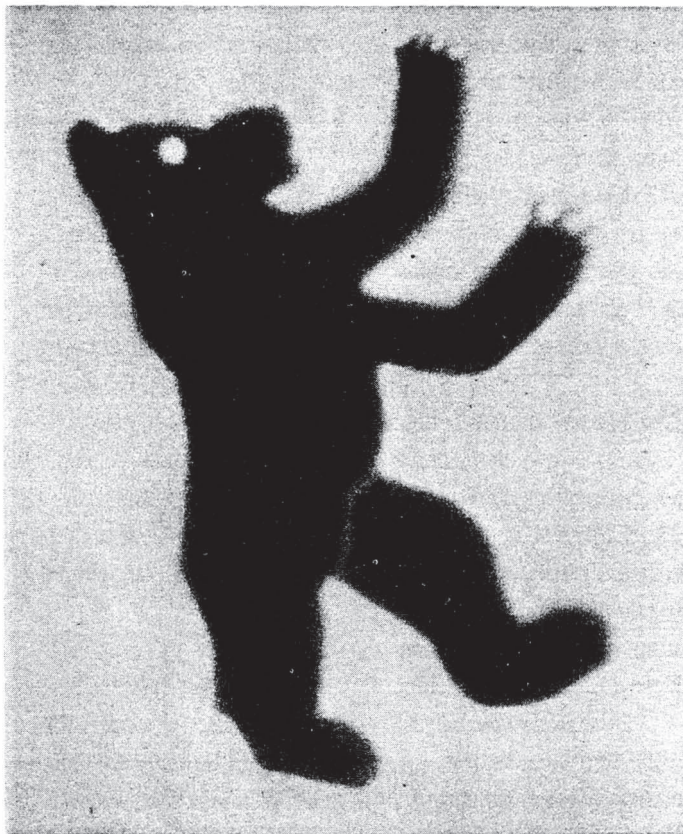
Abb. 3: Leuchtende Tierfigur (Nachleuchtdauer bis zu 5 Stunden bei Raumtemperatur); erzeugt durch aufgelegte lichtundurchlässige Maske bei der Erregung des \text{ZnS}(\text{Cu}) -Schirms mit Weißlicht. (Photo: M. Kischke (FHI, Berlin) und Verfasser; ILFORD HP 5 ISO 400, Blende 4, t_{\text{Bel}} = 40 \text{ s} )
