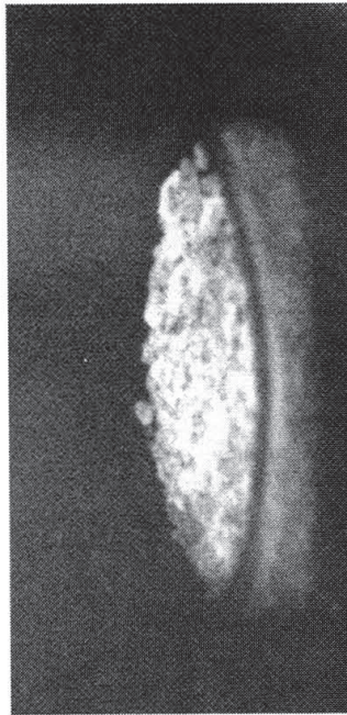
Abb. 7: Röntgeninduzierte Fluoreszenz (VIS) von Uranylnitrat-Hexahydrat ( U_A = 100 \text{ kV} ) /16/
