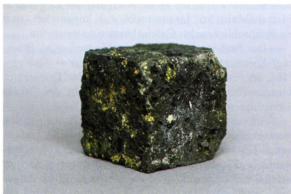
Abb. 3a. Uranmetallwürfel (Gamma-Oberflächendosisleistung = 40 \mu Sv/h, Kantenlänge \approx 5 cm, m \approx 2 kg), vermutlich aus der Anordnung des Höhlenlaboratoriums Haigerloch, 1945 [36]; oberflächliche Umsetzung zu gelben, sekundären Uranverbindungen sichtbar (Aufnahme P. Schöffl).
