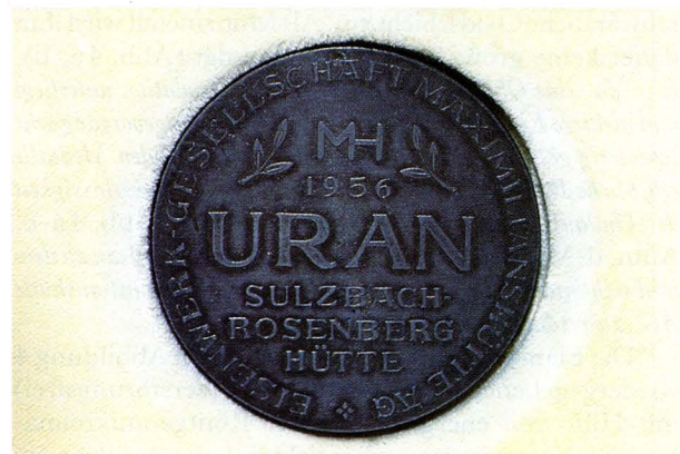
Abb. 4a. Bergbaumedaille aus Uranmetall, Gamma-Oberflächendosisleistung = 33 µSv/h, Uranversuchsbergbau Rudolfstein: Gewerkschaft Werra, Weißenstadt i. F., der Maximilianshütten AG., Sulzbach-Rosenberg (m = 117,3 g; Ø = 52,2 mm, d = 3,1 mm; Zusammensetzung s. Tab. 1).
