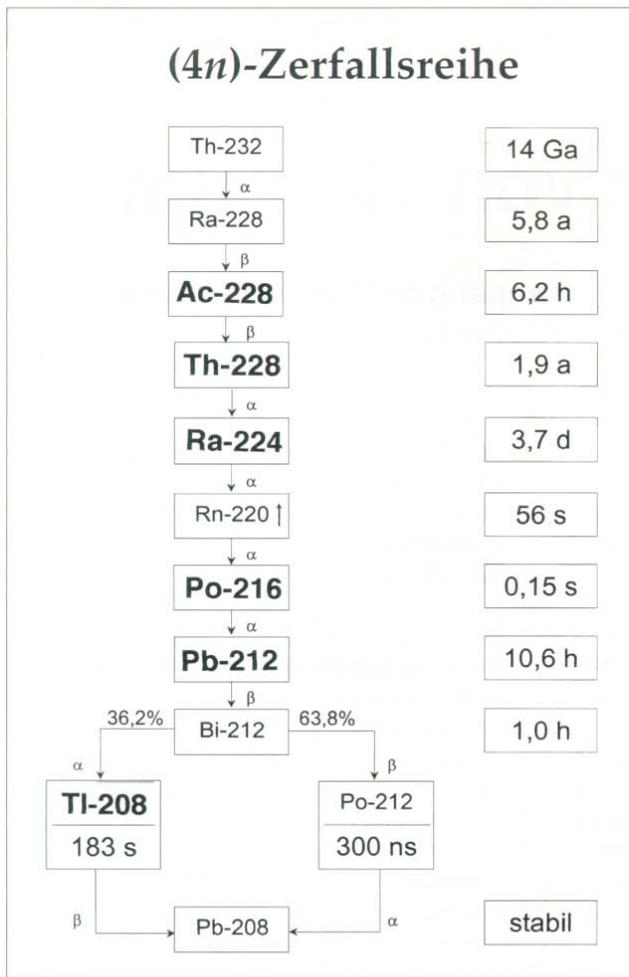
Abb. 1. Thoriumzerfallsreihe ( $A = 4n$ ;  $n \in \mathbb{N}$ ); Nukleardaten aus [2]. Durch die gemeinsame Abtrennung der Thoriumnuklide bei der Erzaufbereitung wächst die Zerfallsreihe dann unabhängig von zwei Stellen aus nach, von  $[^{232}\text{Th}]$ Thorium und von  $[^{228}\text{Th}]$ -Thorium. (Fett gedruckte Nuklide sind gut durch HPGe-Gammaspektroskopie erfassbar.)
