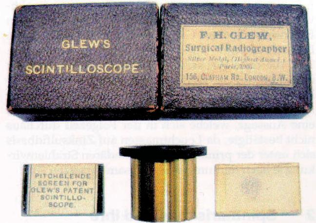
Abb. 2b. Spinthariskop; Bauform C: »Glew's Scintilloscope«; zwischen gläserne Objektträger eingefügte, mit pulverisierter Pechblende verriebene bzw. mit  $^{226}\text{Ra}$ Radium und  $^{210}\text{Po}$ Polonium dotierte Leuchtmass und beigepackte Beobachtungslupe inkl. Abstandshalter (London, Portobello Market, Medical Antiques Shop)
