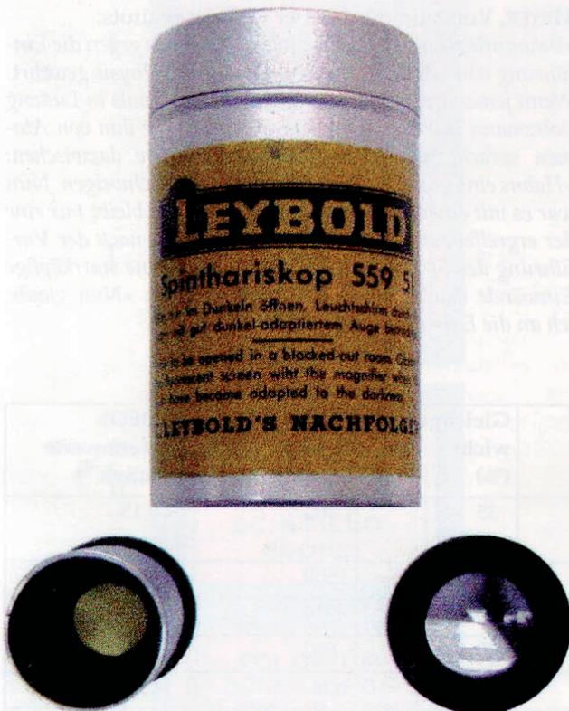
Abb. 1a. Handelsübliches Spinthariskop; Bauform A: Zylindrisch mit verstellbarem Tubus; geöffnet, links mit Blick auf die mit  $^{226}\text{Ra}$ Radium dotierte ZnS(Cu)-Schicht ( $T_{1/2}$   $^{226}\text{Ra}$ Radium = 1600 a); die autoradiolumineszente Leuchtmasse ist geringfügig mit  $^{232}\text{Th}$ Thorium und Folgeprodukten kontaminiert.
