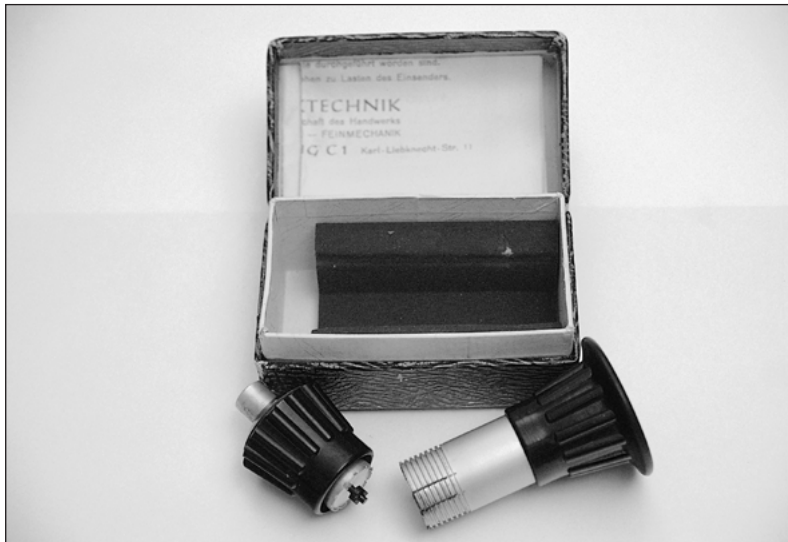
Abb. 3a: Spinthariskop auf der Basis von ^{210}\text{Pb} für den Schulunterricht, produziert in der PGH Feinwerktechnik Leipzig C1, vertrieben vom staatl. Kontor für Unterrichtsmittel und Schulmöbel, Leipzig
