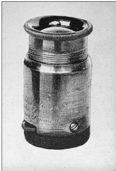
Abb. 1a: Spinthariskop in Tubus-Bauform; so vorgestellt von F. Soddy in seinen 1908 gehaltenen Experimentalvorlesungen „Die Natur des Radiums“ [2].
