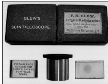
Abb. 6a: Spinthariskop; Bauform: „Glew's Scintilloscope“; zwischen gläserne Objektträger eingefügte, mit pulverisierter Pechblende verriebene bzw. mit ^{226}\text{Ra} und ^{210}\text{Po} dotierte Leuchtmasse sowie beige packte Beobachtungslupe inkl. Abstandshalter (London, Portobello Market, Medical Antiques Shop)
