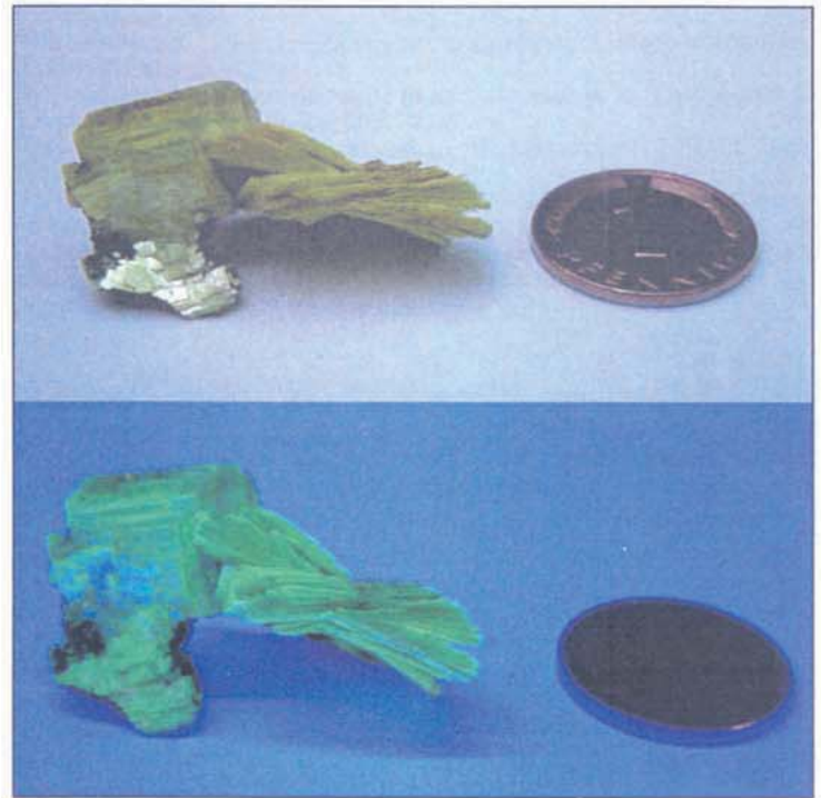
Abb. 3: Sekundäres Uranmineral Uranocircit ( \text{Ba}[\text{UO}_2/\text{PO}_4]_2 \cdot 10\text{H}_2\text{O} ); Bergen, Sachsen) aus der Gruppe der Uranglimmer, aufgenommen im Normal- und UVA-Licht [13].
