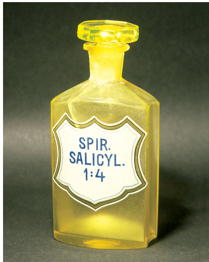
Uran-Apothekerglas aus Wien im Kunst- und UV-Licht. Die Aktivität beträgt A(^{238}\text{U}) = 17000 \text{ Bq} , demnach enthält es 0,4 Gew.-% an ^{238}\text{U} , seine \gamma -Oberflächendosisleistung erreicht 200 nSv/h. Der relativ hohe Kupfergehalt der Glasmatrix (0,3 Gew.-%) schwächt die Uranyl-Fluoreszenz nur bedingt.
