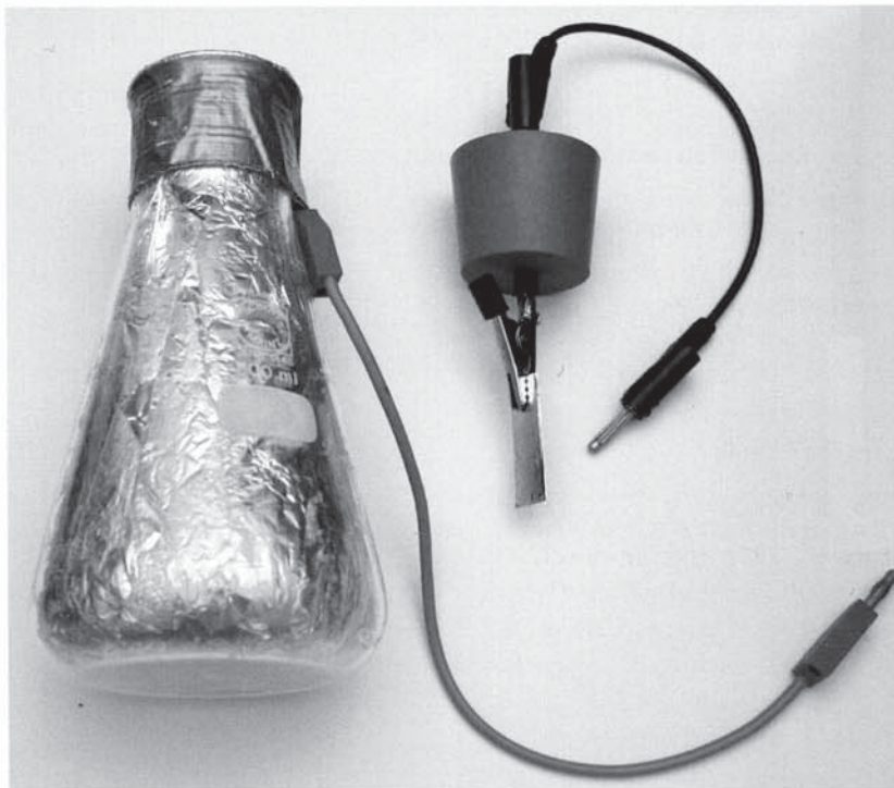
Abb. 8.6.5/1: Aufbau einer Rutherford'schen Thoriumkuh mit eingeklemmter Platinwechselkathode [52, 66]
