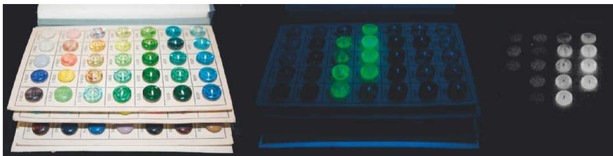
Abb. 5a: X-Stimulation von Uranylumineszenz in Uranglasproben (Jaco, Standard Glas Colours, Jablonex, I. Musterkarte mit 140 Glasknöpfen aus Gablonzer Stangenglas; verwendet 1918/38). Von links nach rechts: Normal-, UVA-Licht, X-Exposition (W-Anode, UA = 200 kV, IA = 20 mA; Luca-S-Belichtungszeit = 0,077 s, EM-Level = 228)
