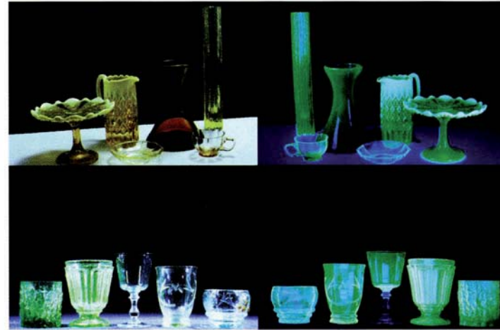
10 Zusammenstellung gelb- und grüngefärbter Uranglasmatrices der Sammlung G. Lieckfeld im Normal- und UVA-Licht (Aufnahmen Lieckfeld).
