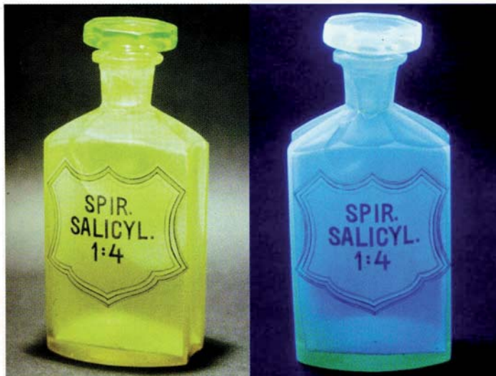
21 Uranoffizinalglas (h = 17 cm, b = 7 cm; m = 342 g). Die Röntgenfluoreszenzanalyse ergibt neben der Bestätigung des radiometrisch ermittelten Urangehalts von 0,4, einen Kupfergehalt von 0,3 Gewichtsprozent; letzterer ist offenkundig in der gegebenenem Matrix nicht imstande die Uranylfluoreszenz zu löschen [Bä 1995].
